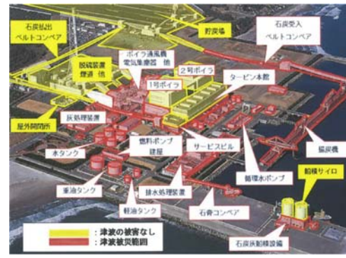
津波による設備被害範囲
