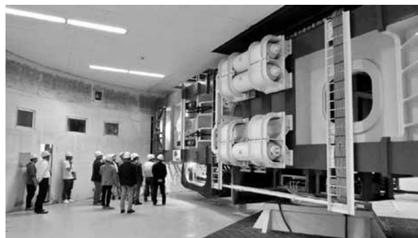
写真5. 大型動的遠心力載荷試験装置
