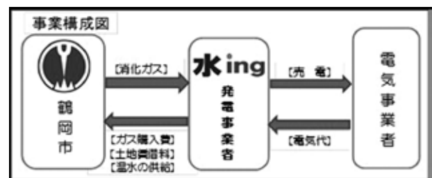
図1. 消化ガス発電スキーム
