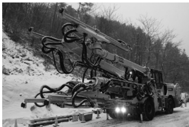
写真 3. 4 ブームフルオートコンピュータージャンボ
