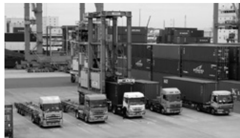
写真3. ストラドルキャリアによるコンテナ積込み
