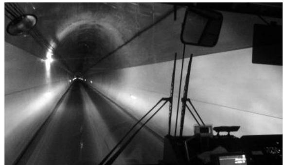
写真2. トンネル内の走行(走行環境確保の塗装)
